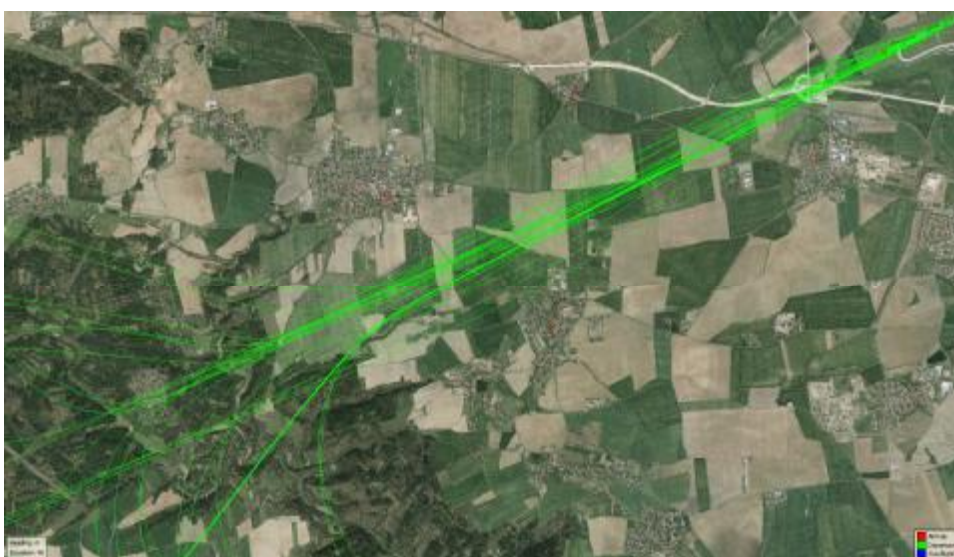
Obr. B.3 Dráhy letu testovaného sledu turbovrtulových dopravních letadel při odletu z RWY 24
